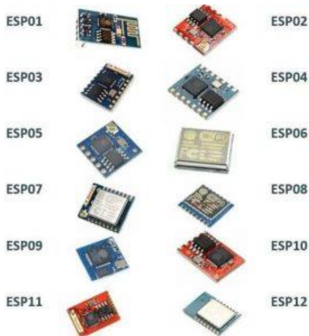
Figura 25: Tipos de módulos ESP, basados en el SoC ESP8266
