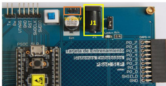
Figura 133: Terminales de Alimentación de Tarjeta de Expansión Modular Fuente: Elaboración propia
