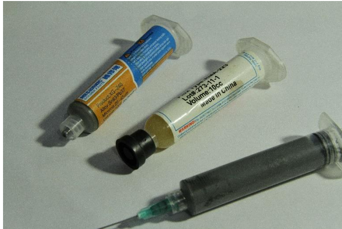
Figura 126. Estaño líquido, pasta flux y mezcla de ambos en jeringa. Fuente: Elaboración propia
