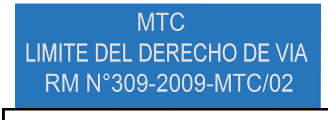
**Figura N° 59:** Modelo de Murete para su instalación en la Carretera: La Costanera, ancho de Derecho de Vía: 40m. (Es decir 20m. a cada lado del eje de la VÍA) RM.N°309-2009-MTC/02
