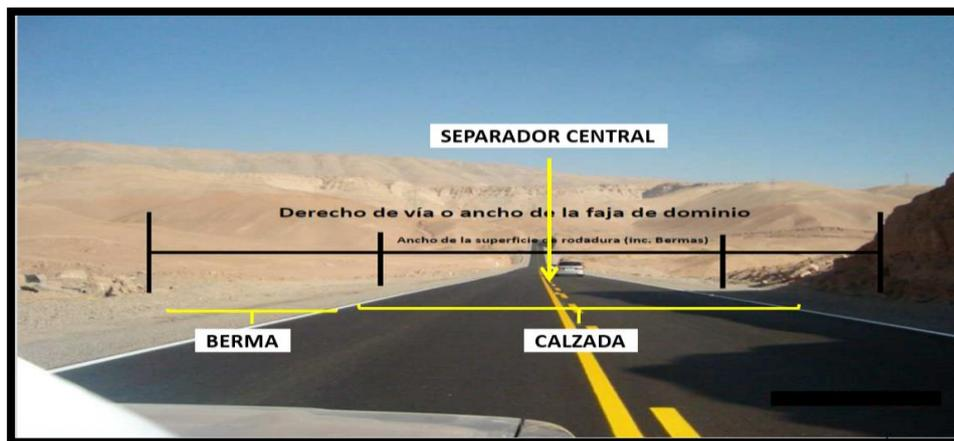
**Figura N° 17:** Estructura de los elementos que conforman el dominio de la franja de Derecho de Vía.
