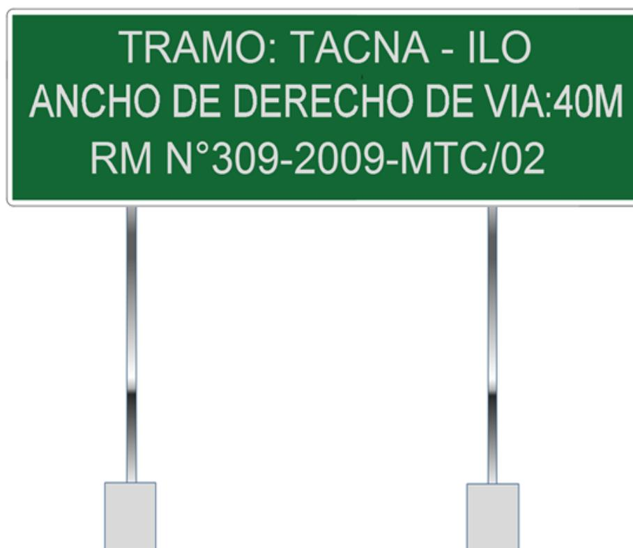
**Figura N° 57:** Señal informativa con sus elementos estructurales para la Carretera: La Costanera, ancho de Derecho de Vía: 40m. (Es decir 20m. a cada lado del eje de la vía) RM.Nº309-2009-MTC/02.
