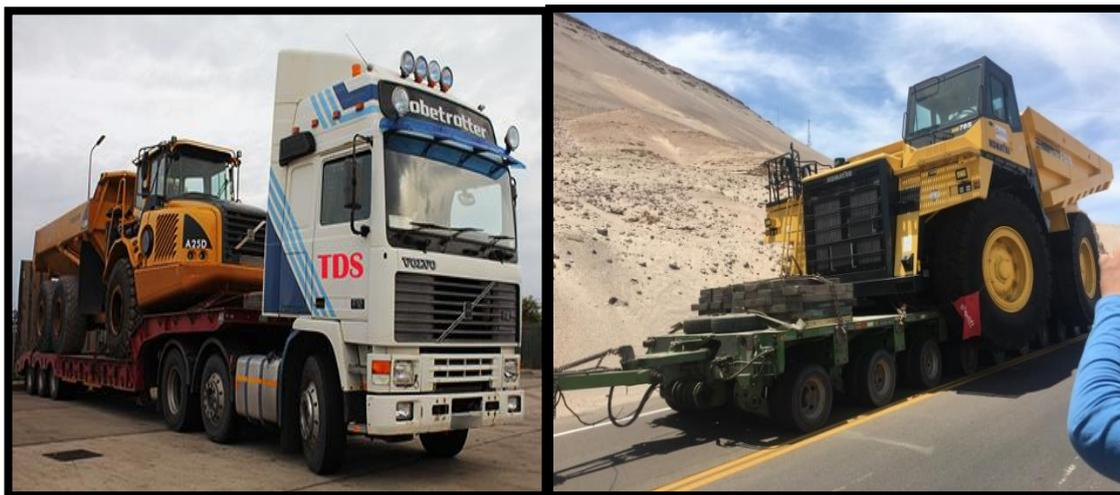
**Figura N° 32:** Camas bajas transportando cargas anchas, Maquinaria para minería de la zona sur del país, circulando en la Carretera Nacional: PE-1SD “La costanera Sur”
