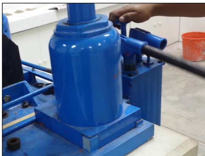
Foto 9. Se observa que para realizar el ensayo en la máquina de tracción, es necesario palanquear con un tubo galvanizado en el orificio.
