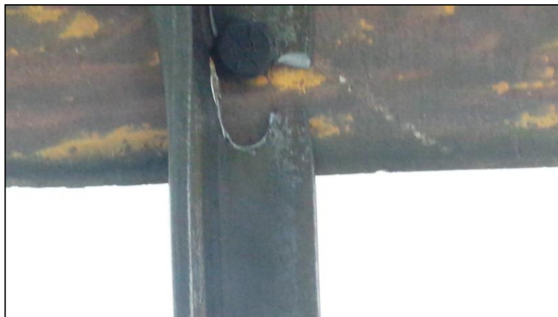
Foto 4A. Vista de falla a la rotura
