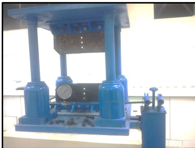
Foto 3. En esta figura se observa la máquina de ensayos a tracción. Los perfiles son colocados en las cartelas y empernados en los orificios de la cartela.
