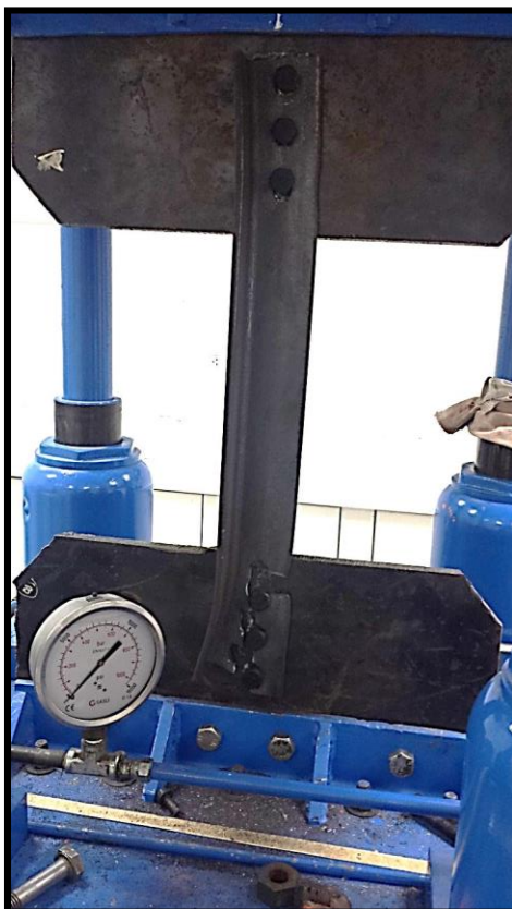
Foto 6. Vista de falla en perfil de acero. La dirección en la que falla por bloque de corte, generalmente se dio en la parte superior, en algunos casos se da en lado inferior, ello se debe a que en esa área el acero empieza a ceder.
