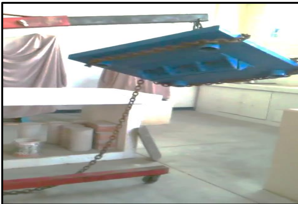
Foto 2. En esta figura se observa la colocación de la plancha superior, con la ayuda de una grúa tecele manual
