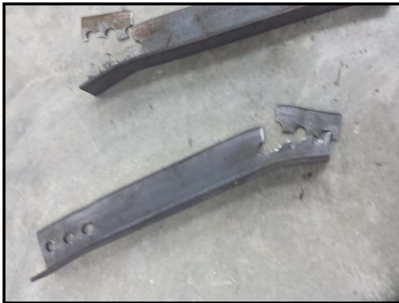
Foto 10. Falla típica producida en los perfiles de acero
