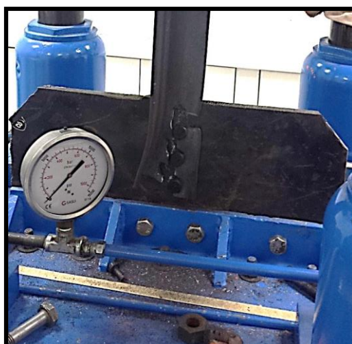
Foto 7. Luego de observar al perfil pasar por el límite plástico y finalmente llegar al punto de ruptura, es necesario mantener la vista en el manómetro, donde nos indicará que valor se obtuvo en cada ensayo
