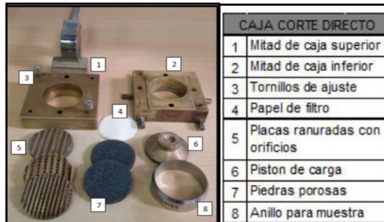
Figura 16. Elementos de la caja de corte
