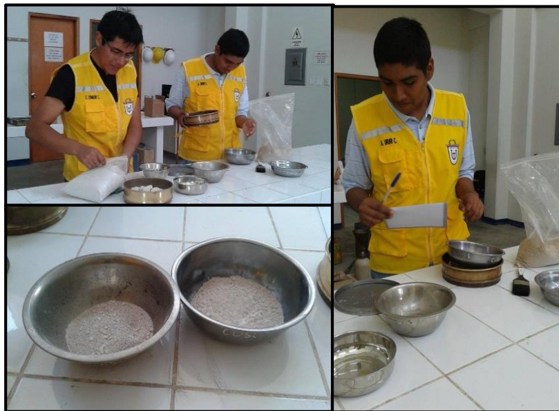
Figura 38. Ensayo de Humedad Natural, calicata C-5
