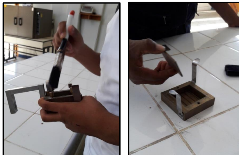
Figura 46. Preparación y armado de la caja de corte
