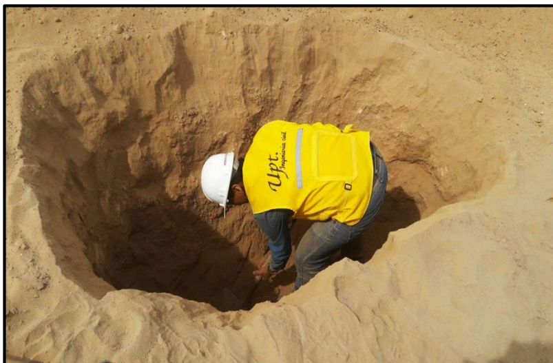
Figura 30. Calicata C-1, suelo SM, prof. 2.5m
