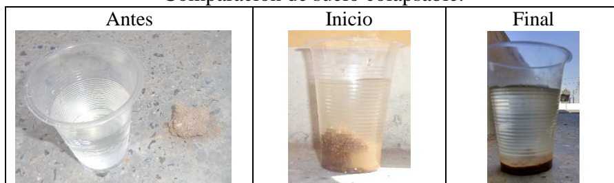
Fotografía n.º 5 Comparación de suelo colapsable.
