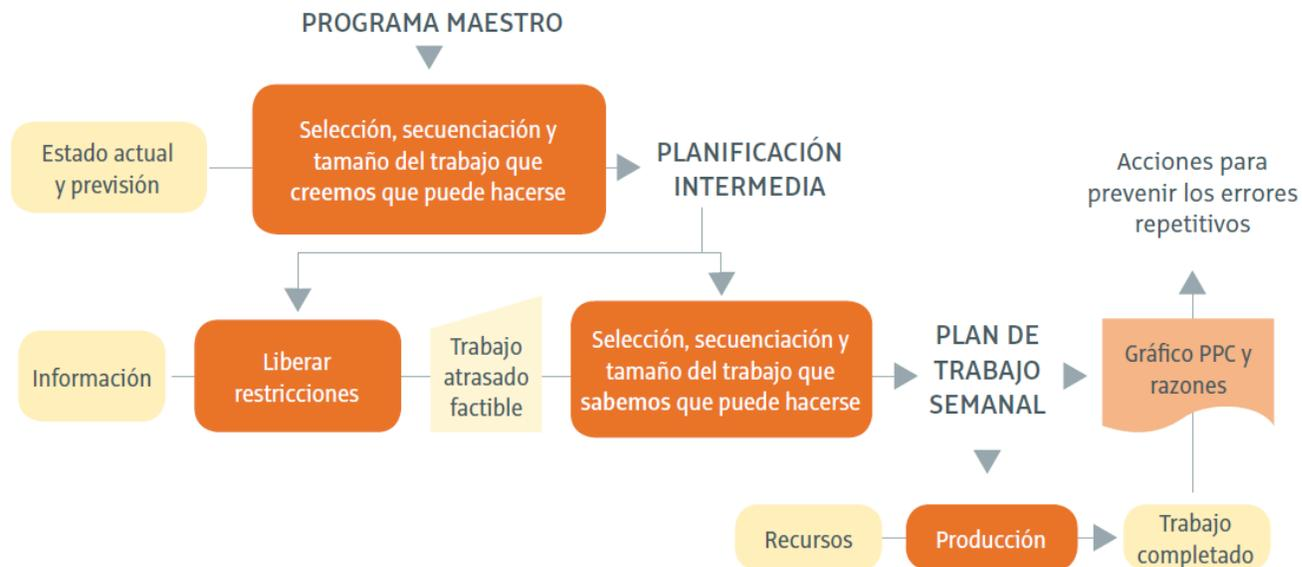
Figura 14: Modelo general de Planificación del Proyecto usando LPS. Fuente: Glenn Ballard<sup>(14)</sup>
