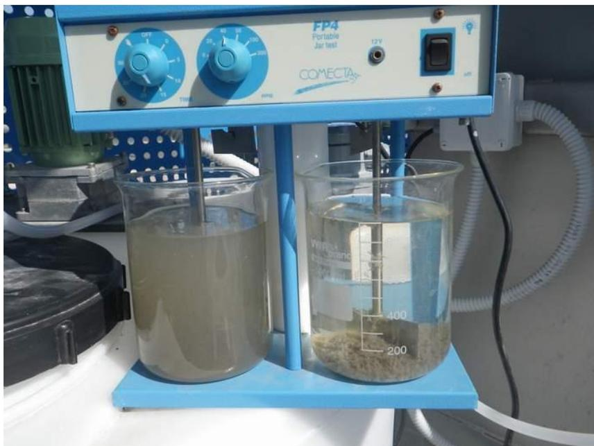
Figura N° 28: Proceso de floculación
