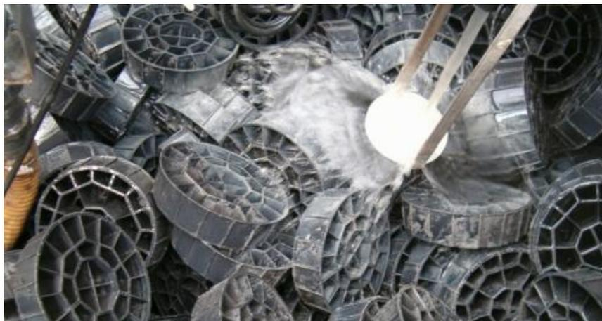
Figura N° 20: Soportes de polipropileno para filtro percolador
