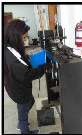
*Figura 17: Ensayo de Corte Directo – Fuente: Elaboración Propia*
