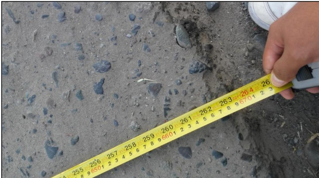
Fotografía 02.- Toma de medida de ancho de la calzada de la av. Jorge Basadre Grohmann del distrito de Pocollay, tramo av. Jorge Basadre Grohmann Este – av. Basadre y Forero.
