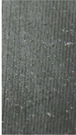
*Figura 9.* Exudación de alta severidad.
