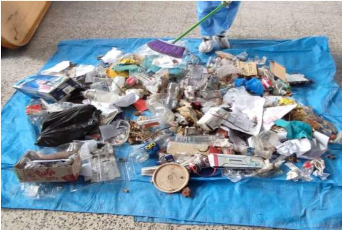
Aplicación del método de cuarteo para tener más homogenizados los residuos sólidos.
