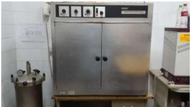
FIGURA 04: PROCESO DE DESECADO EN LA ESTUFA A 45° C.
