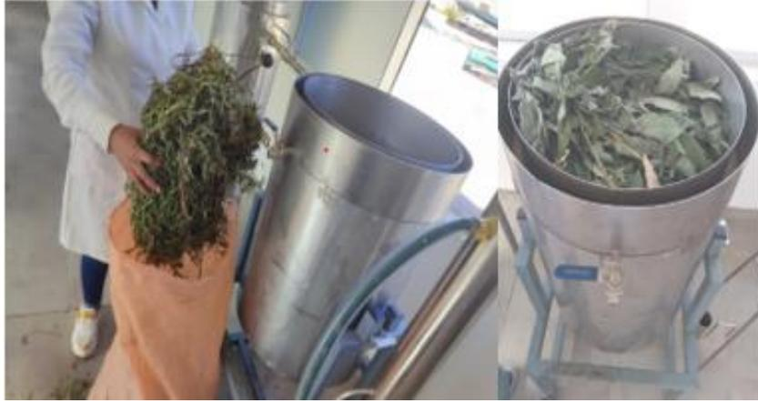
*Equipo de extracción por arrastre de vapor en funcionamiento*
