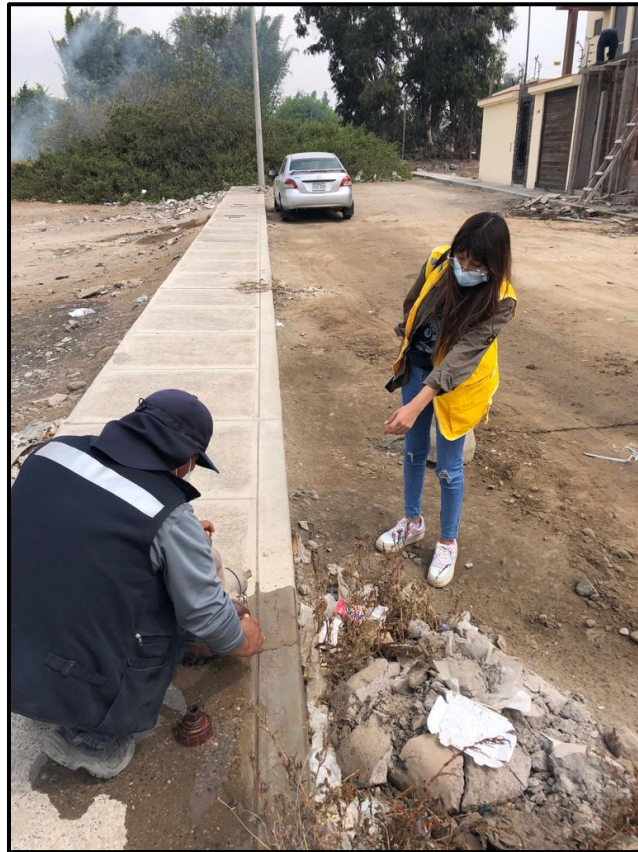
Foto 7: Toma de presión en la Av. Tarapacá
