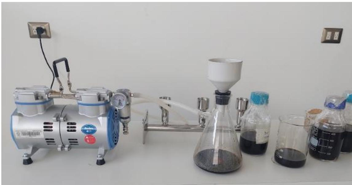
Sistema de filtrado para la obtención del té de orujo
