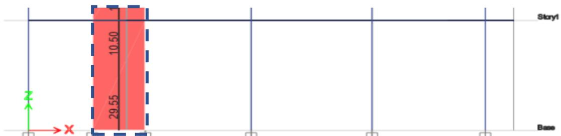
Luego observamos que nos da la longitud del elemento de borde que necesita la placa como se observa en la Figura 52, donde indica que se necesita un elemento de borde de 24,025 x 33,33, redondeando sería 25x30.
