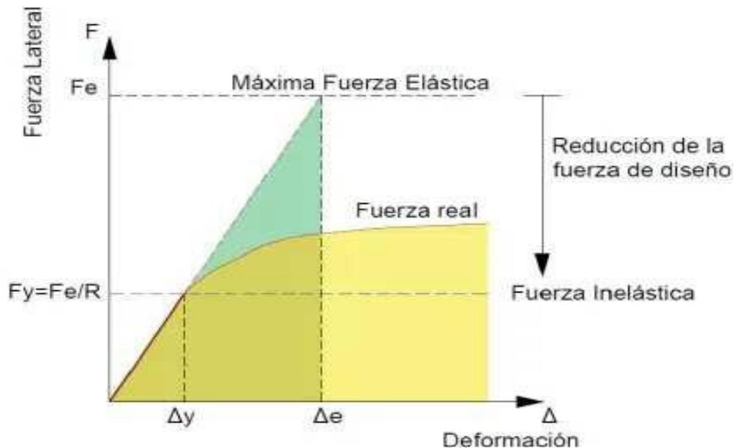
*Nota.* Se muestra el procedimiento que se realiza para el análisis sísmico según la norma peruana donde se aplica un factor de reducción "R" según el sistema estructural. Obtenido de "Análisis sísmico no lineal de estructuras" (2020) y de la norma E.030 (2018).
