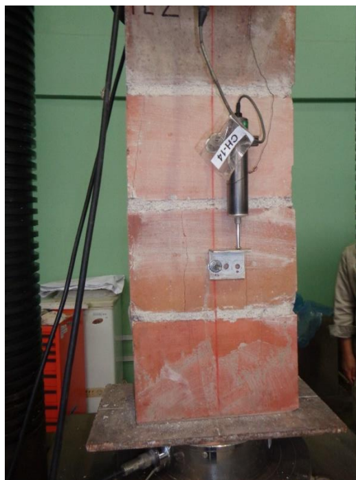
Foto 2. Pila PL-2, Grietas verticales en la zona central
