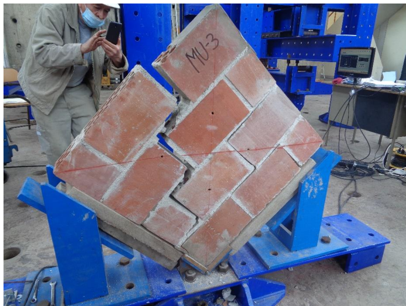
Foto 10. Falla de murete MU-3
