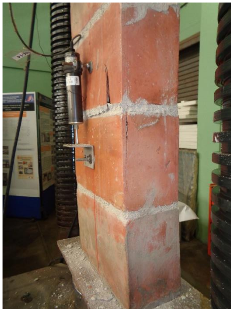
Foto 4. Falla de la pila PL-4, grietas en esquinas y zona central
