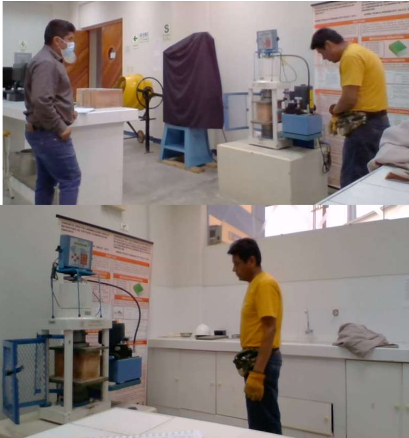
Ensayo de Resistencia a la compresión en la unidad de albañilería
