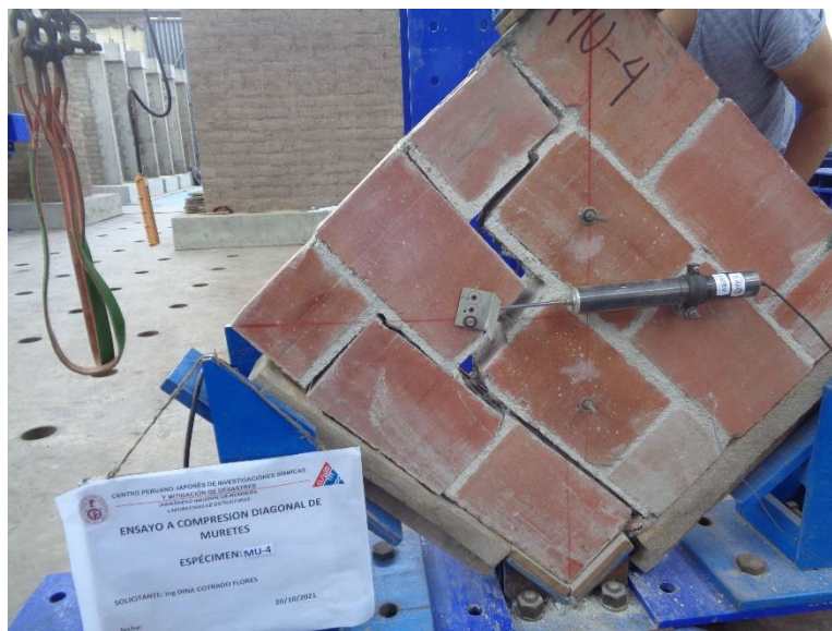
Foto 12. Falla de murete MU-4
