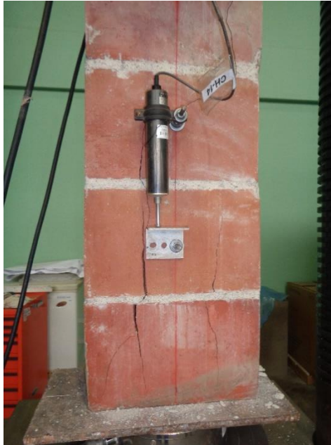
Foto 3. Falla de la pila PL-3, Grietas verticales
