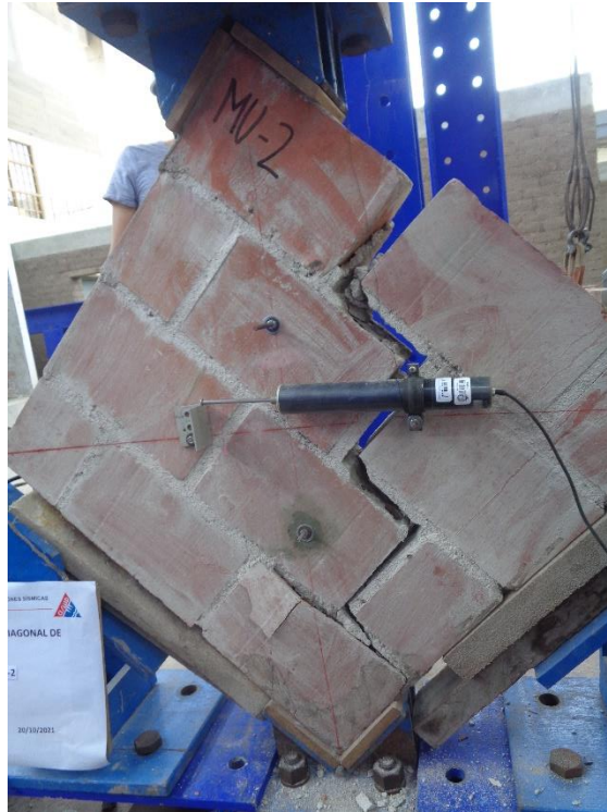
Foto 9. Falla de murete MU-2
