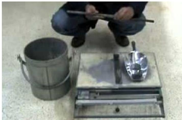
*Nota.* Instrumentación según norma ASTM C- 29.
