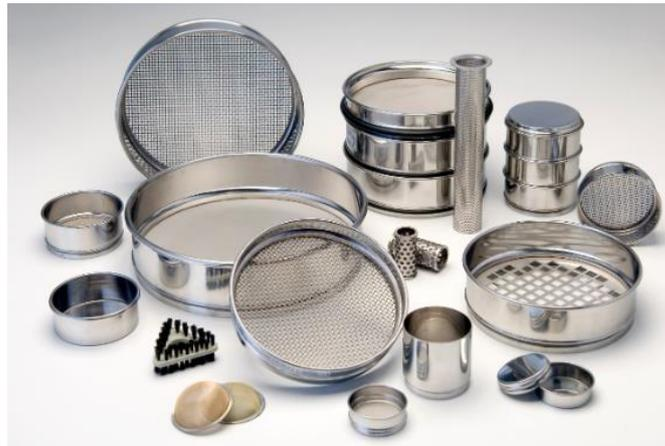
*Nota.* instrumentación según norma ASTM C – 136.
