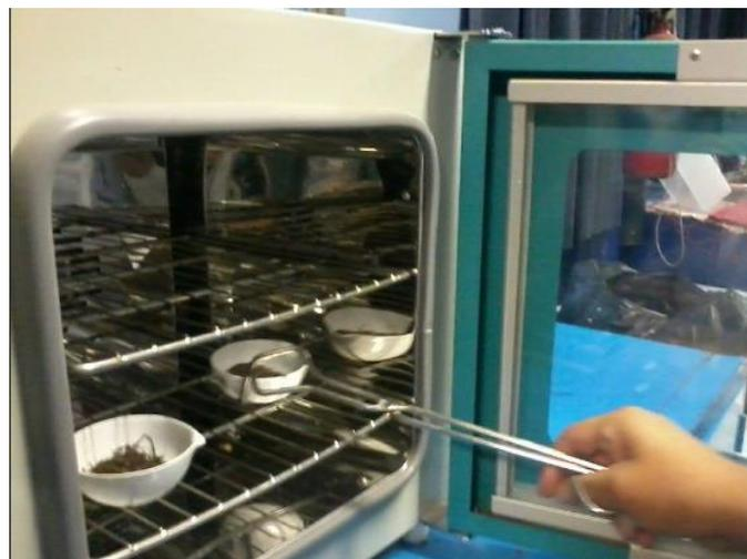
*Nota.* Instrumentos y equipos según norma ASTM D - 2216
