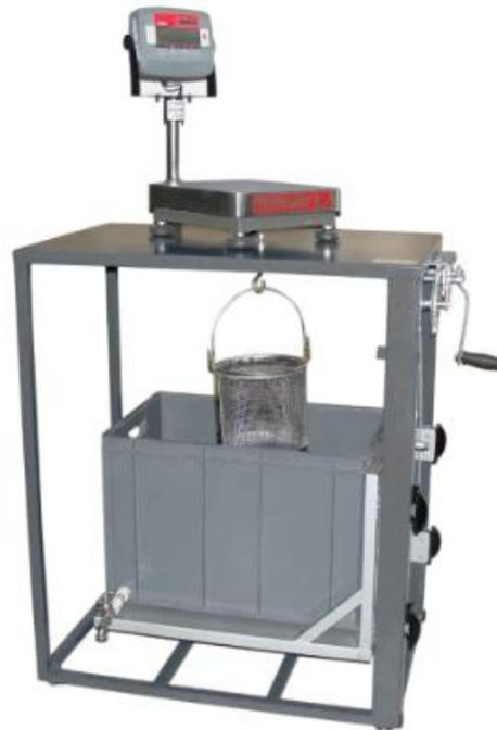
*Nota.* instrumentación según norma ASTM C – 127.
