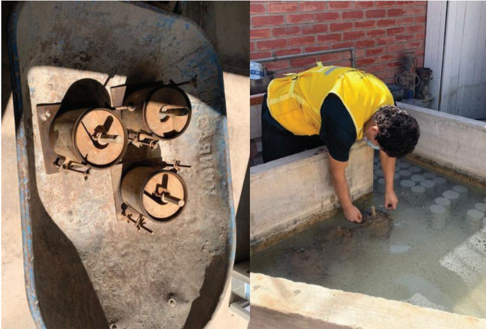
*Nota.* Preparados los especímenes del ensayo se procede a sumergir los moldes en agua durante 96 horas.
