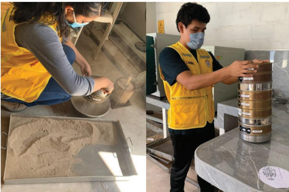
*Nota.* Tamizado del material para separar las partículas a utilizar en el ensayo.
