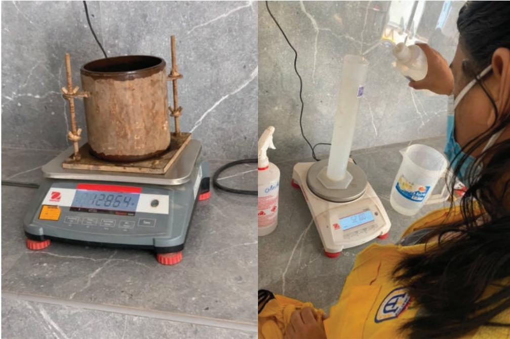
*Nota.* Información del peso de la muestra compactada y el agua para alcanzar la humedad óptima.
