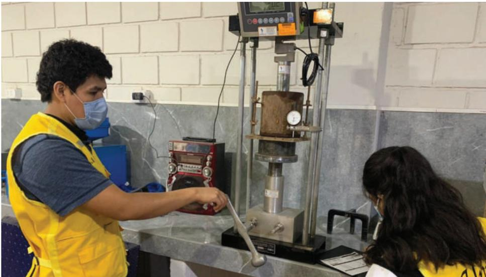
*Nota.* Se aplica la carga de forma que el pistón se desplace a una velocidad constante. .
