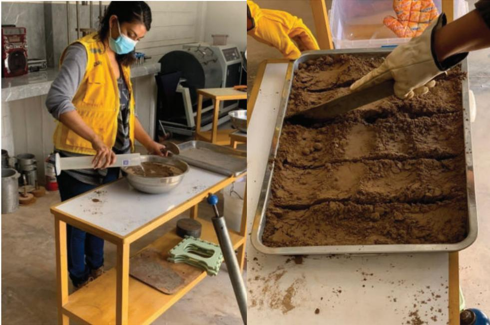
*Nota.* Imágenes de la saturación del material y de la distribución de la muestra para el ensayo.
