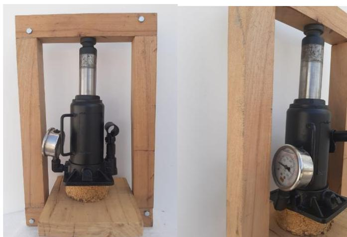
**Anexo 7: Máquina de compresión;** fabricada con madera de aguano, emite presión a través de un manómetro de 0 a 350 bar, instalado en una gata hidráulica de 10 toneladas.
