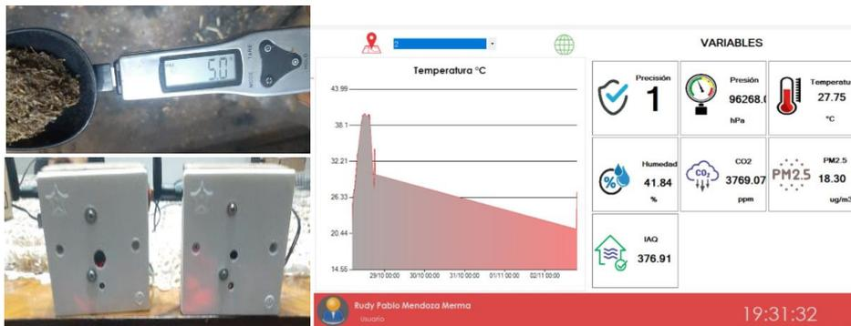
**Anexo 10: Módulo de medición de CO<sub>2</sub>;** (sensor marca Bosch modelo BME 680).
