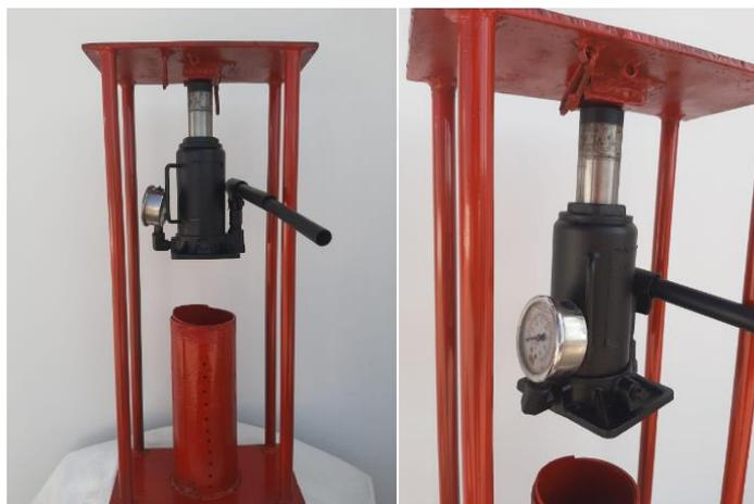
**Anexo 3: Briqueteadora de acero;** emite presión a través de un manómetro de 0 a 350 bar, instalado en una gata hidráulica de 10 toneladas.
