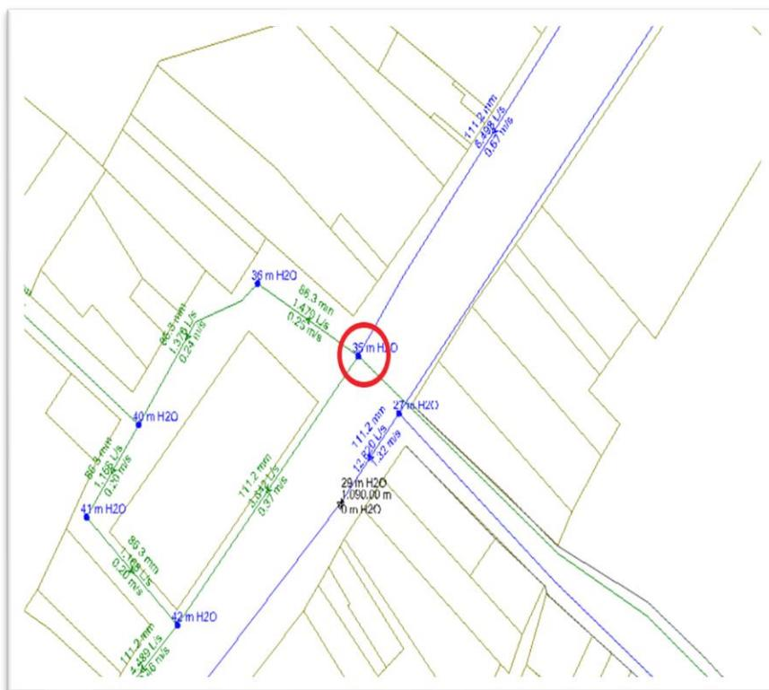
Para la lotización propuesta (Caudal de diseño 37.5 Litro/segundo) se propuso una conducción de 6 pulgadas que comunica las 2 válvulas reguladoras de presión propuestas y bifurcaciones de 4 pulgadas hacia las entradas de cada asociación de vivienda, posteriormente las ramificaciones serán de 3 pulgadas.
