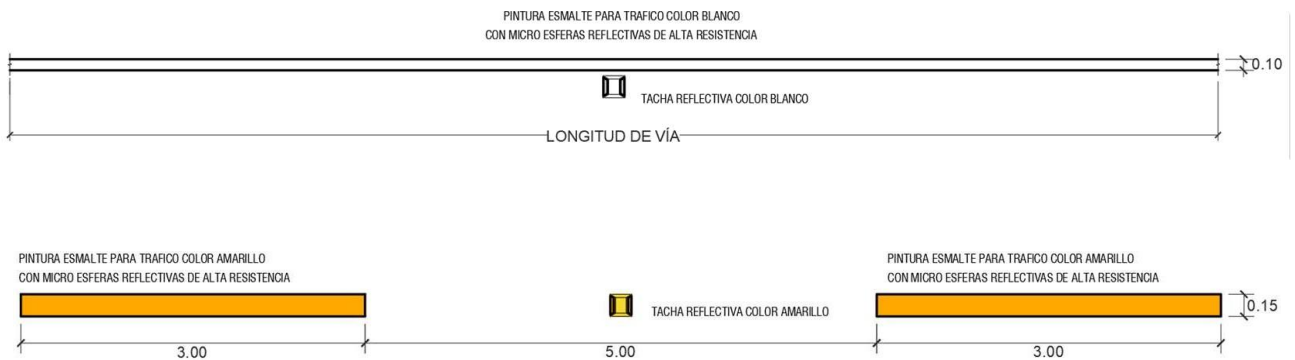
Figura 21 Líneas continuas y discontinuas en el pavimento
