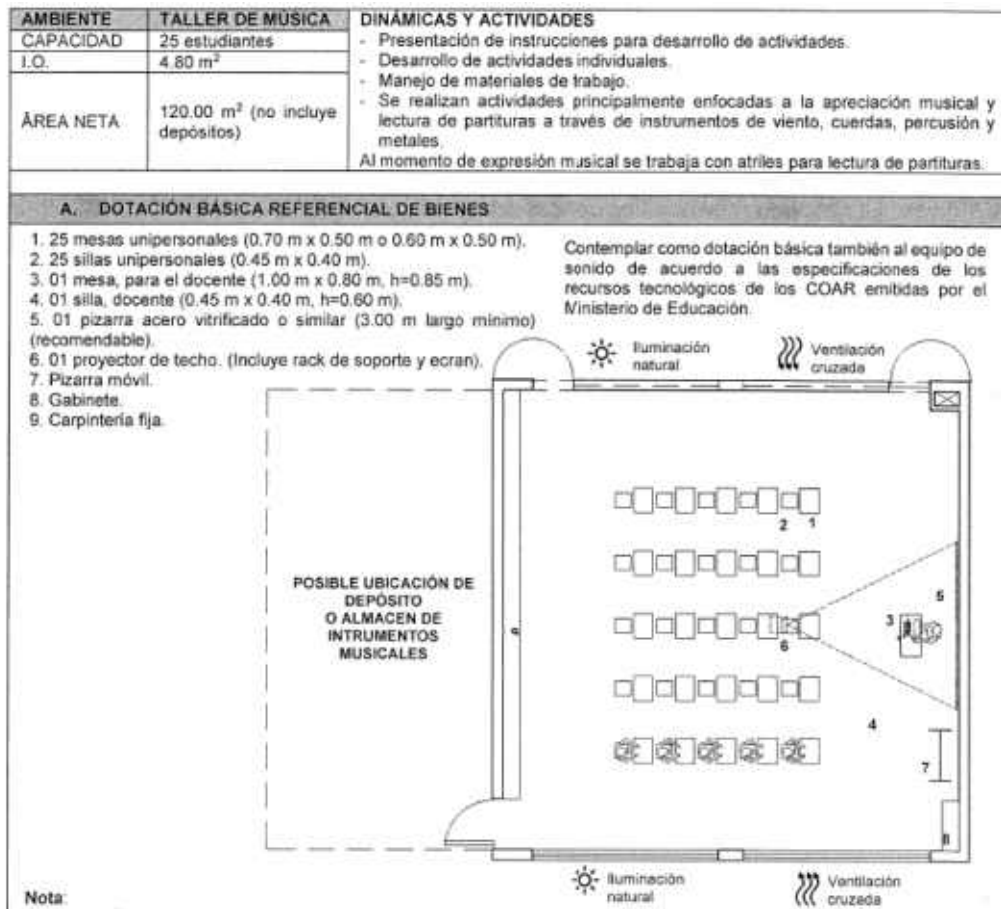
Imagen 14: Esquema referencial de áreas de talleres de música, fuente N.T. Diseño COAR.
