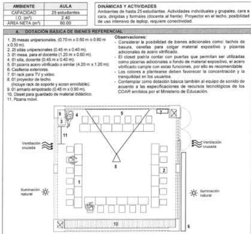
Imagen 07: Esquema referencial de un aula, fuente N.T. Diseño COAR
