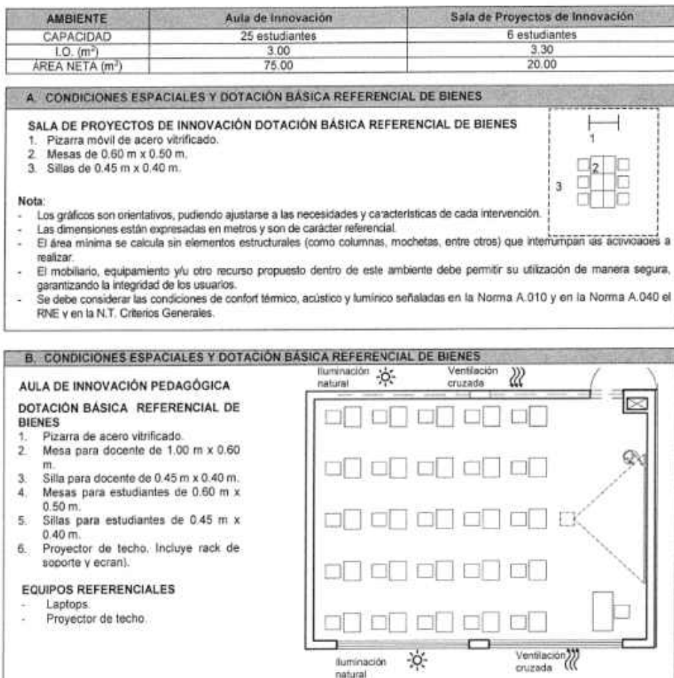
Imagen 09: Esquema referencial de áreas de innovación, fuente N.T. Diseño COAR.
