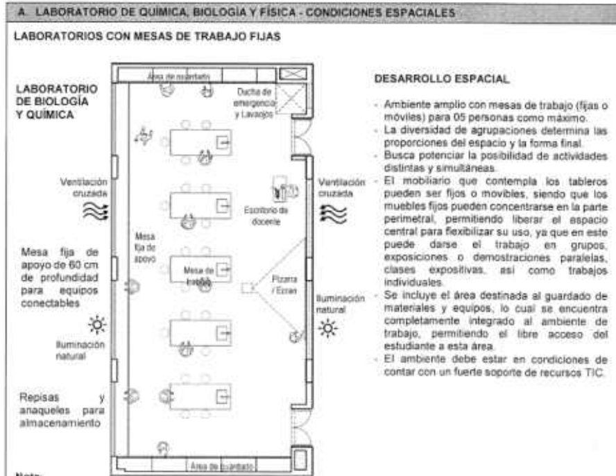
Imagen 10: Esquema referencial de áreas de laboratorios, fuente N.T. Diseño COAR.
