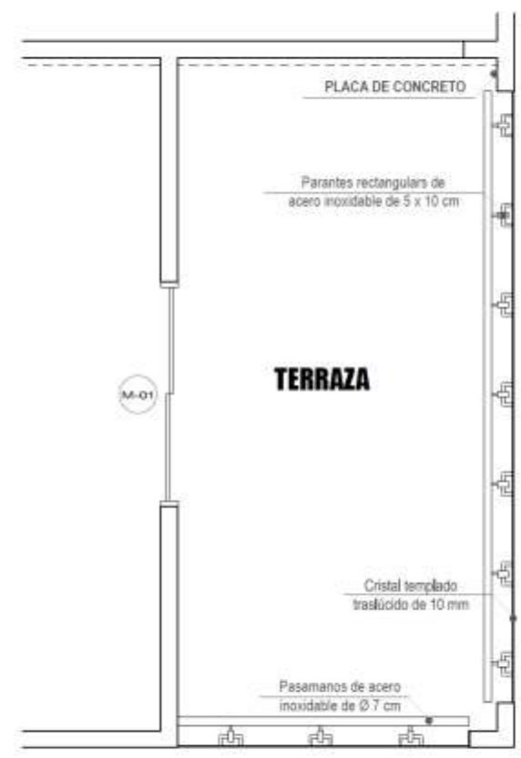
DETALLE 01 - BARANDA DE ALUMINIO Y VIDRIO ESC: 1/20
