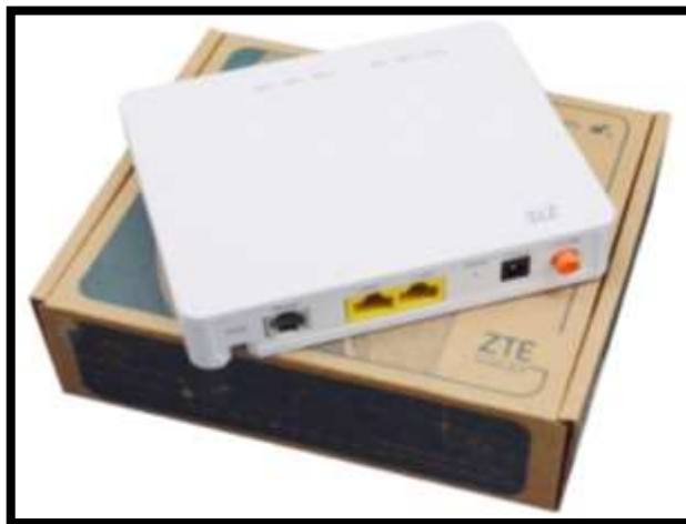
Figura 71. Vista de planta equipo terminal de red.
