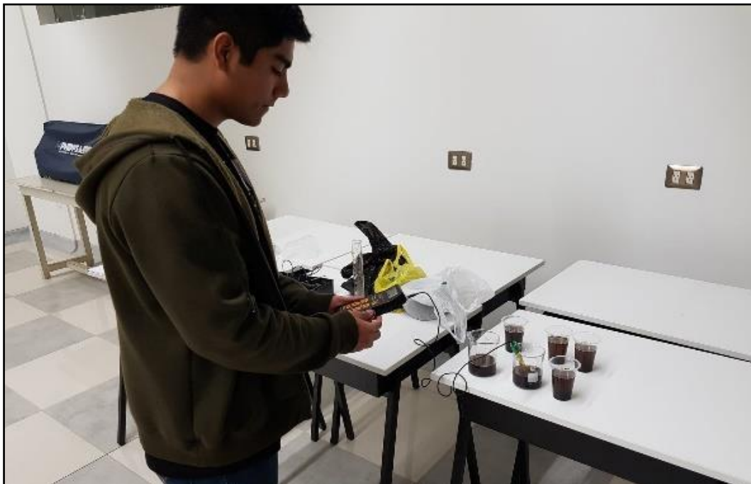
Fotografía N°C25. Medición de pH con ayuda de un multiparámetro.
