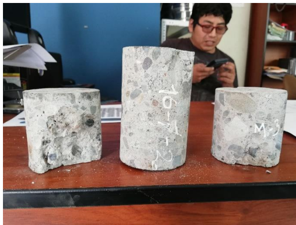
Figura 22. Muestras después de ser comprimidas.
