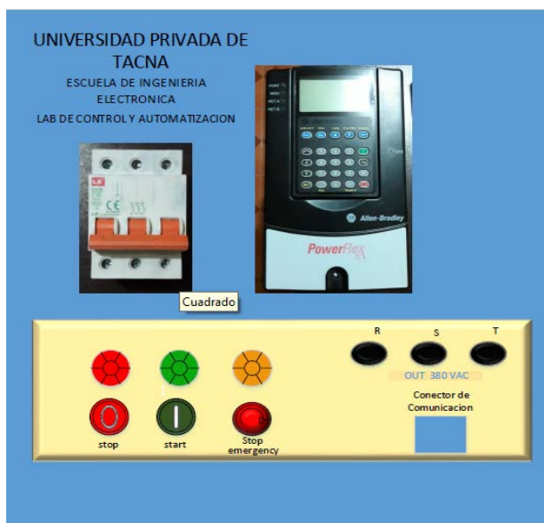
Figura 76: Módulo de variador de frecuencia implementado (Fuente propia)
