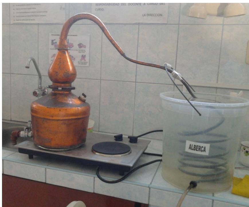
Foto 6. Alambique experimental de 5 Lt., de capacidad.
