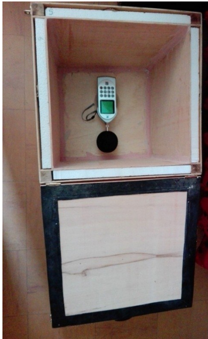
Figura 37: Caja de insonorización con poliestireno expandido
