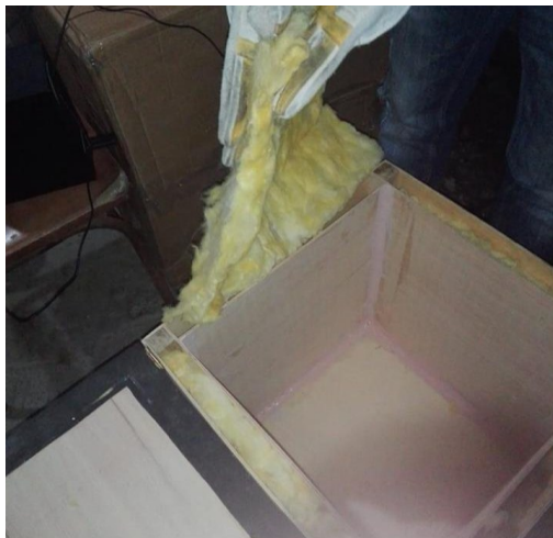
Figura 38: Caja de insonorización con lana de vidrio
