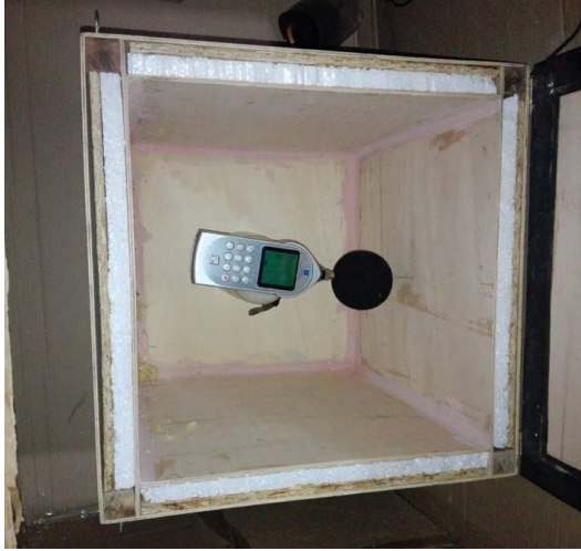
Figura 39: Caja de insonorización con Poliestireno expandido y madera OSB
