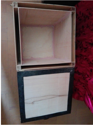
Figura 35: Caja de insonorización sin barreras acústicas
