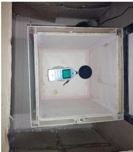
Figura 36: Caja de insonorización con madera OSB
