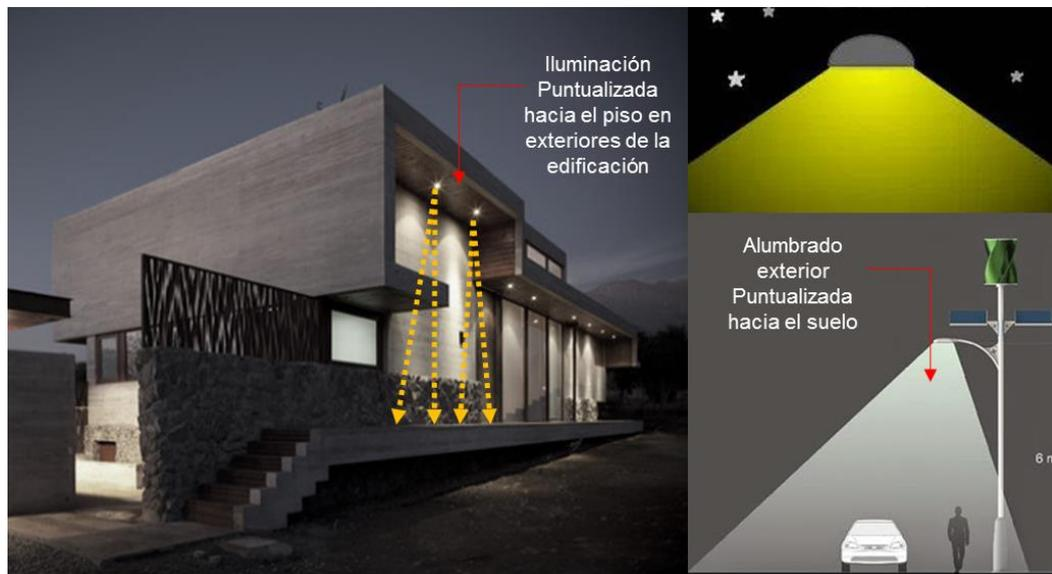
Figura 113: Orientación de iluminación artificial
