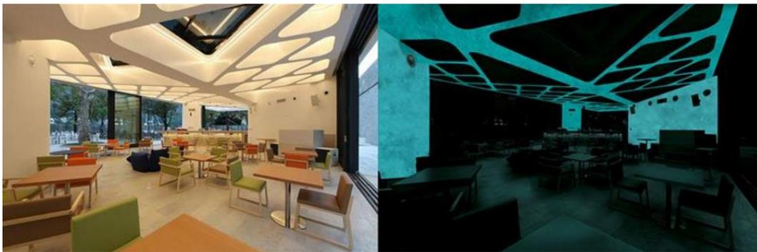
*Figura 47:* Aplicación del Cemento emisor de luz en falso techo
