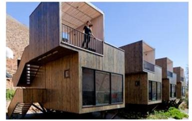
El exterior de la habitación tipo observatorio es de madera de Pino Radiata, sin proceso de secado, cepillada, y de cantos redondeados, cubierta con barniz incoloro tipo gel para climas extremos. (Pastorelli, G. 2012).
