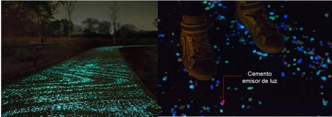
Figura 114: Aplicación del Cemento emisor de luz en caminerías.
